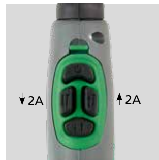
Spínač Up/Down se 4 tlačítky, spínání a nastavování svařovacího proudu, přepínání mezi svařováním a TIG-A Tack). Růst/pokles proudu skokově po 2A. Podržení plynule zvyšuje/snižuje proud
