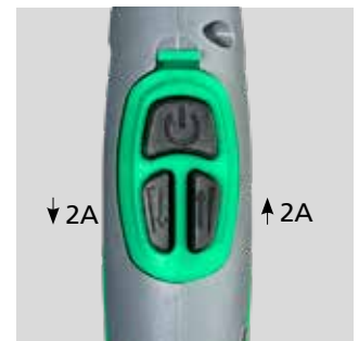
Spínač Up/Down se 3 tlačítky, spínání a nastavování svařovacího proudu. Růst/pokles proudu skokově po 2A. Podržení plynule zvyšuje/snižuje proud.
